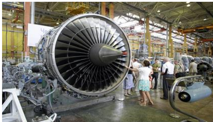
Мал.3. - Авіаційна турбіна, на базі якої було запропоновано створити промислову повітряну холодильну машину зразка 1992 р
