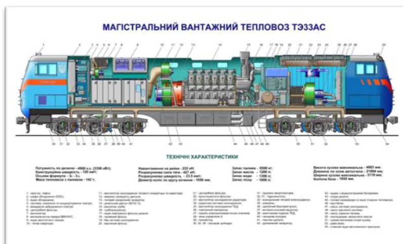
Рис. 4. Обладнання тепловоза ТЭ33АС
