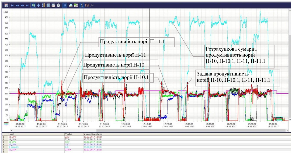
Рис. 2. Вікно «Тренди» з діаграмами зміни продуктивності норій ПТЛ перевантаження зерна із залізничного транспорту на судно при вивантаженні однієї зчіпки вагонів кукурудзи.
