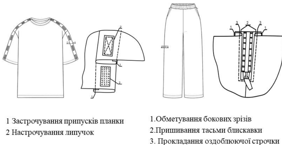
Рис.2. Складальні схеми адаптивного одягу футболки та штанів чоловічих
